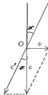
Рис. 3. Расчет величины абберационного смещения: c — скорость света в неподвижной системе отсчета, c' — в системе отсчета наблюдателя, v — скорость движения наблюдателя, \alpha — абберационное смещение
